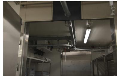
eine moderne Rohrbahnanlage verbindet Anlieferung, Produktion und die Lagerräume miteinander. Ausgestattet mit einer Waage lässt sich rationell und genau arbeiten.
